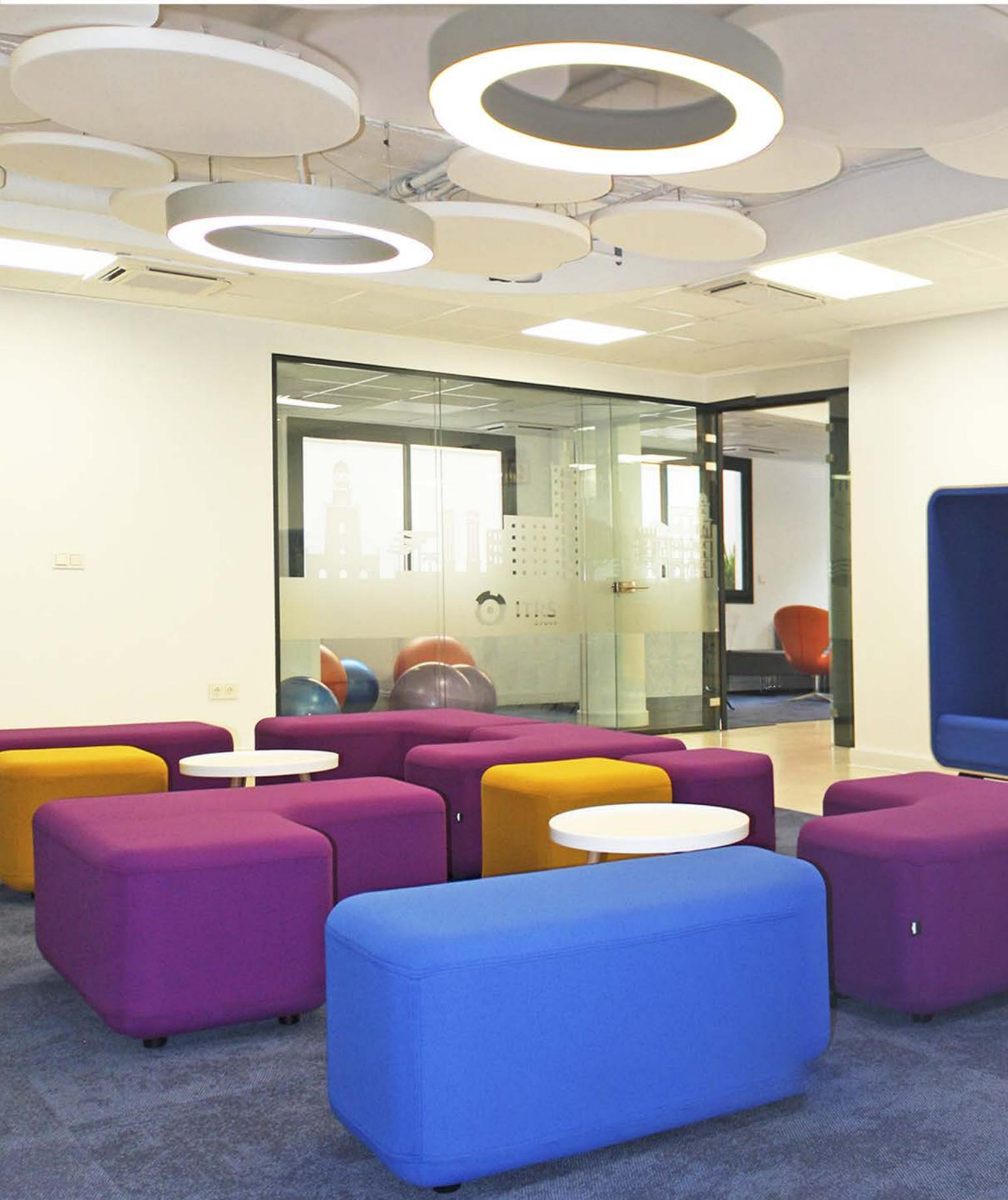
Para el acondicionamiento acústico de la oficina, se instalan paneles acústicos fonoabsorbentes de distintas formas geométricas y mobiliario acústico, de tal manera que se alcance el tiempo de reverberación óptimo, que oscila entre 0,4 - 0,6 s.
